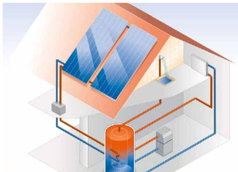
auf die Kollektorfläche auf dem Dach treffen, reichen in der Regel aus, um diese 60 Prozent zu erreichen – auch bei Wolken verhangenem Himmel. Für die Gewinnung der übrigen 40 Prozent benötigen Verbraucher einen Heizkessel.
